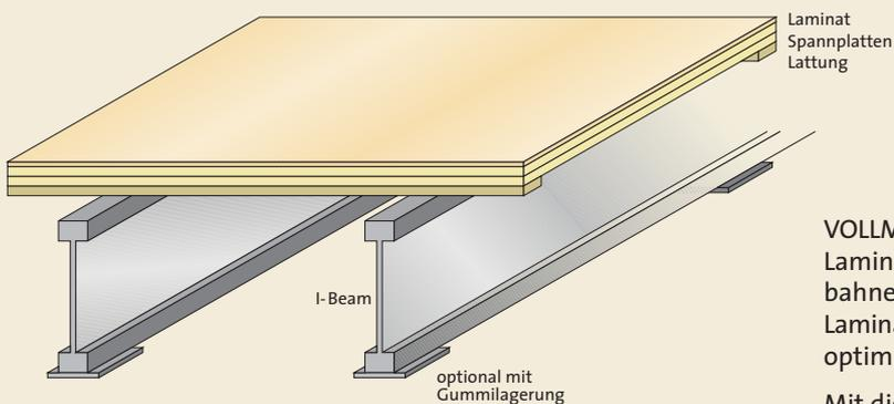
VOLLMER Sport Bowlingbahnen werden aus speziellen HPL-Laminatplatten gefertigt, welche ausdrücklich für Bowlingbahnen entwickelt wurden. Präzision und Stabilität der Laminatplatten und des Bahnunterbaus gewährleisten einen optimalen Lauf der Bowlingbälle.
